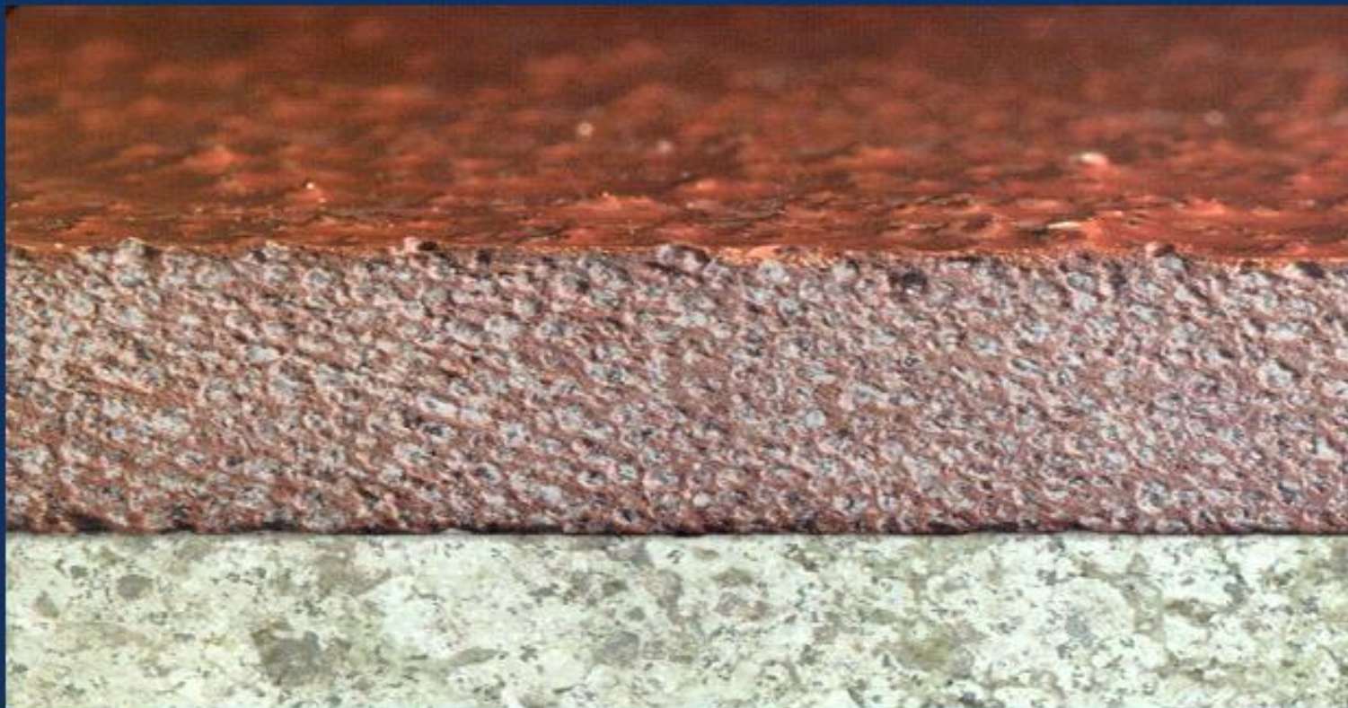
Serie Overkote - Rico en Resina - Corte Transversal
